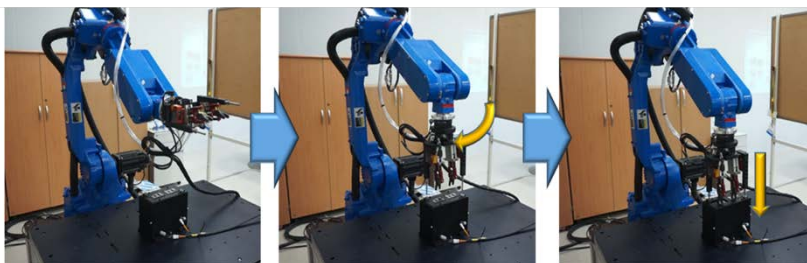
1. 그리퍼를 통한 부품 파지 수행 2. 부품을 지그 삼입 전 위치로 이동 3. 부품을 지그에 삼입 및 품질 검사 수행
