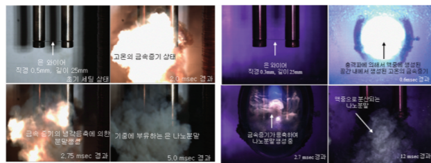
[ 기중 및 액중 전기폭발 나노분말 생성 과정 고속카메라 사진 ]
